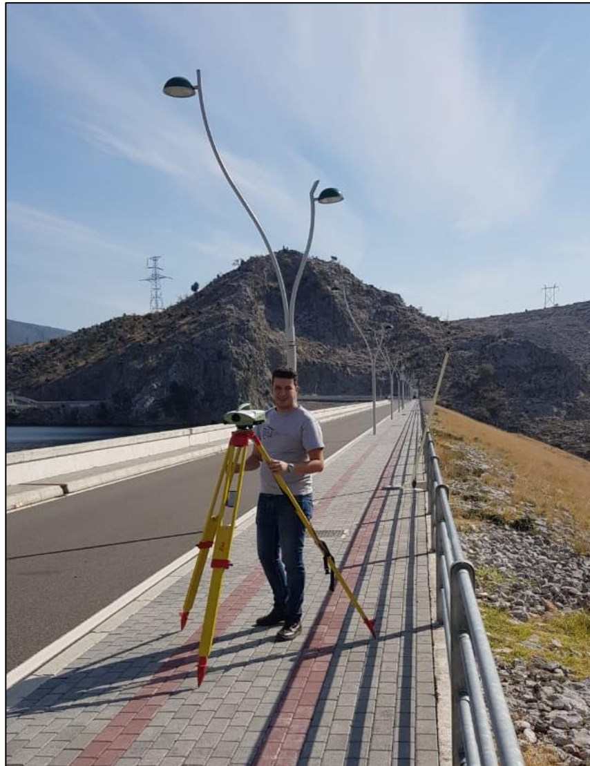
Figura 4-13 Pamje gjatë matjeve me Nivelën DNA10 Leica (Koço, 2018)
