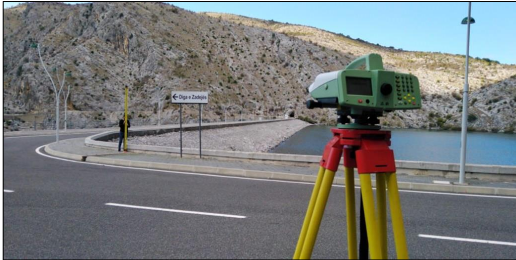
Figura 4-5 Instrument Nivela Digitale Leica DNA10 (M.Koço, 2015)
